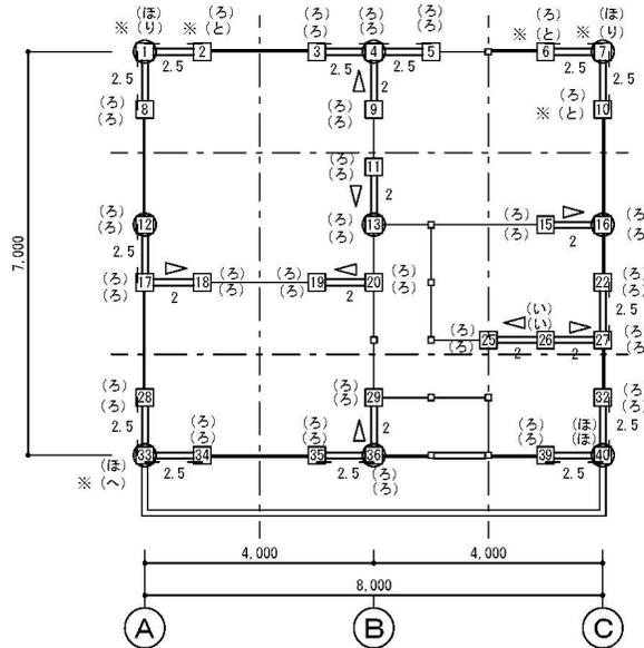
1階柱頭柱脚金物算定平面図
